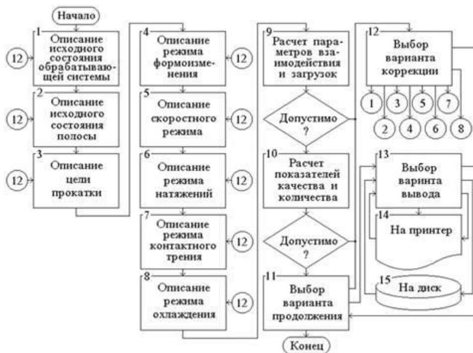
1.2-сурет. Илемдеу режимдерін автоматты жобалаудың жалпылама алгоритмі.
